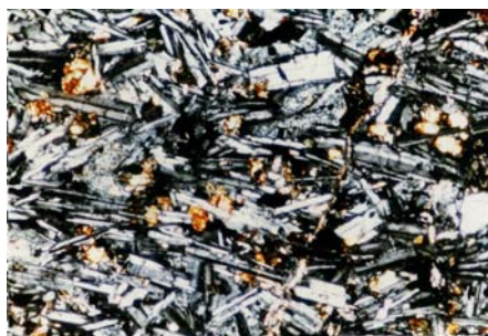
شکل ۱۳- بازالت تا حدی دگرسان شده با بافت پیلو تاکسیتی (بزرگ‌نمایی 25\times ، xpl).
