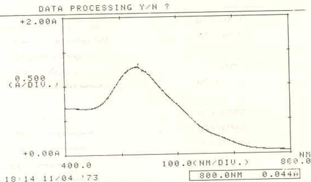
شکل ۱: تعیین تحریری  $\lambda_{\max}$  برای کمپلکس "میزیم- اریوکرم بلاک T".
