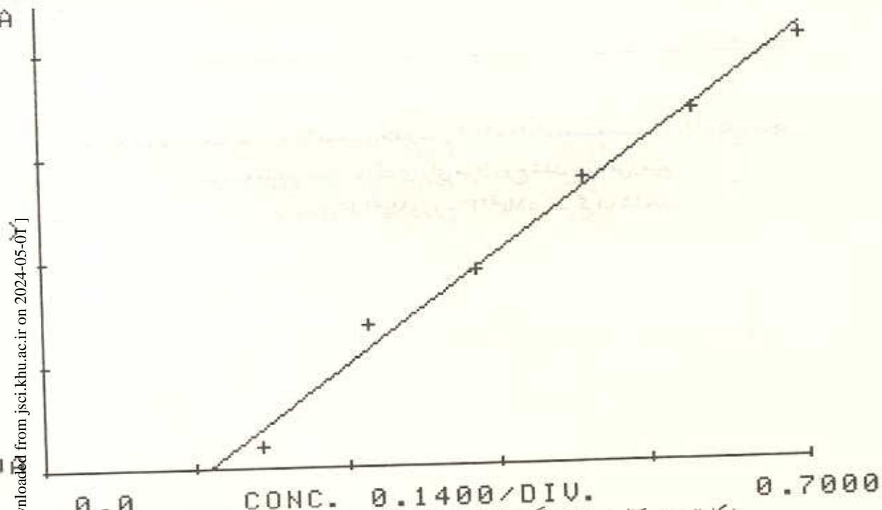
شکل ۲: منحنی کالیبراسیون دستگاه UV-Vis مدل 160 A برای اندازه گیر غلظت کمپلکس "میزیم- اریوکرم بلاک T".
