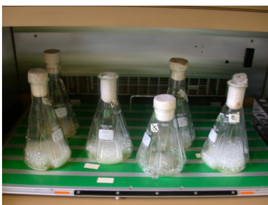
شکل ۴. تولید رامنولیپید درون ارلن‌های ۱۰۰۰ میلی‌لیتری در یک شیکرانکوویاتور (۳۷°C و ۱۲۰ rpm) در حین تولید رامنولیپید کف تولید می‌شود.
